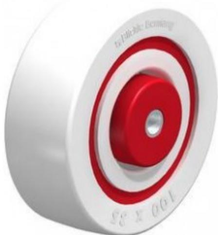
· **轮胎/胎面:** 采用优质耐冲击尼龙6，通过红色弹性实心橡胶缓冲层降低噪音（-10分贝），滚动阻力低，便于在光滑地面上行走，非常耐磨。
