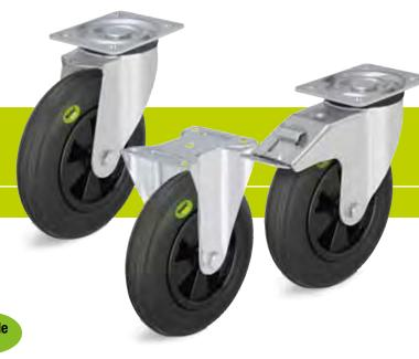
单轮: WPP 系列 - 轮胎: 采用软橡胶"Blickle Soft", 50° Shore A (轮径为 260 mm 时, 另带硬质橡胶芯), 操作舒适性极高, 吸收噪音效果极佳, 特别保护地面, 黑色。
